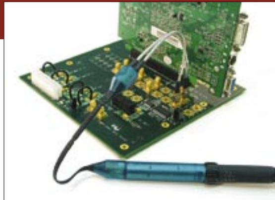
Sondes différentielles de 11 GHz
