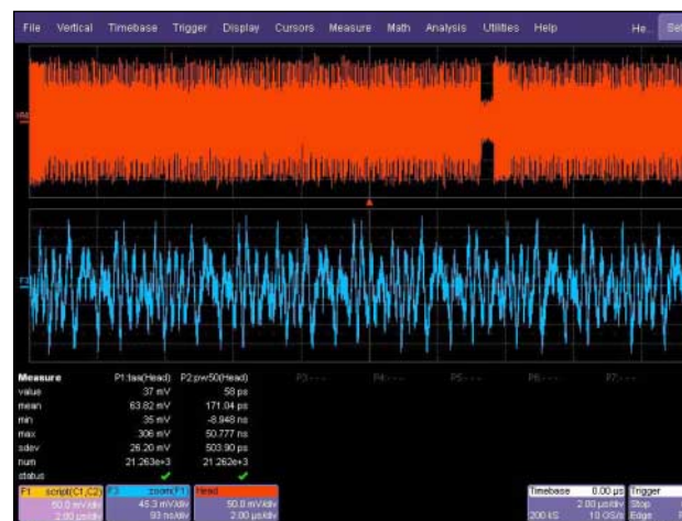
IDEMA 規格評価 taa, pw50 捕捉した全てのセクタ (または特定したセクタ) に対する測定が行えます。全体波形 (上段) と拡大波形 (下段) のそれぞれのtaa, pw50の値が、グリッドの下に表示されています。
